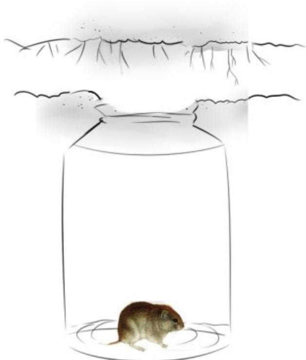
Рис. 2. Схема установки ловушки в нору крота для отлова возможных квартирантов
